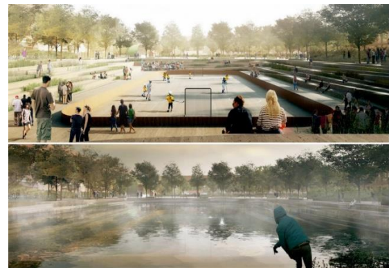
Hình: khu vui chơi kết hợp làm mặt chứa nước dự phòng mùa mưa
