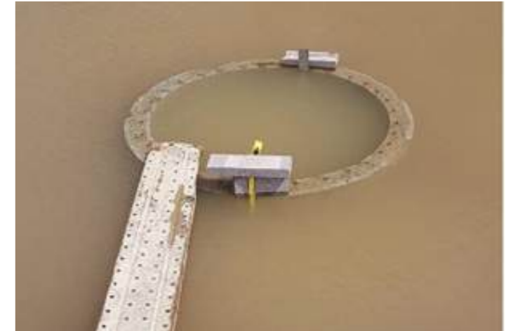
Hình 5.4: Thử nghiệm độ dẫn thủy lực trong điều kiện thực tế
