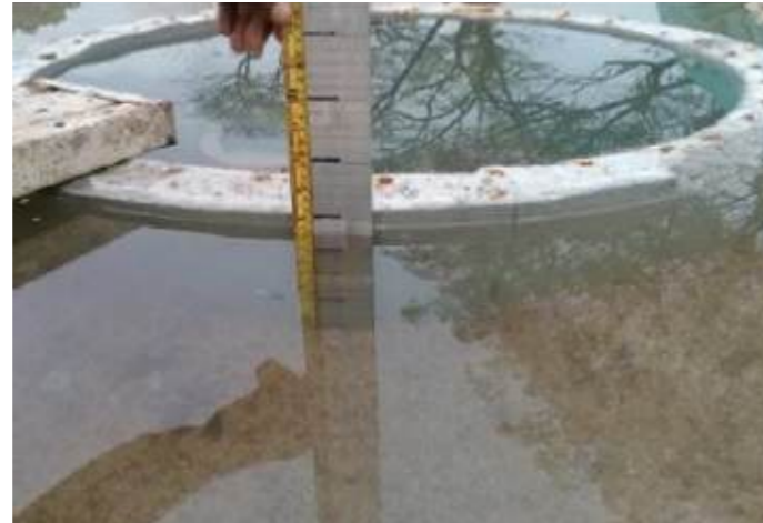
Hình 5.10: Tham số kiểm soát trong kiểm tra rò rỉ
