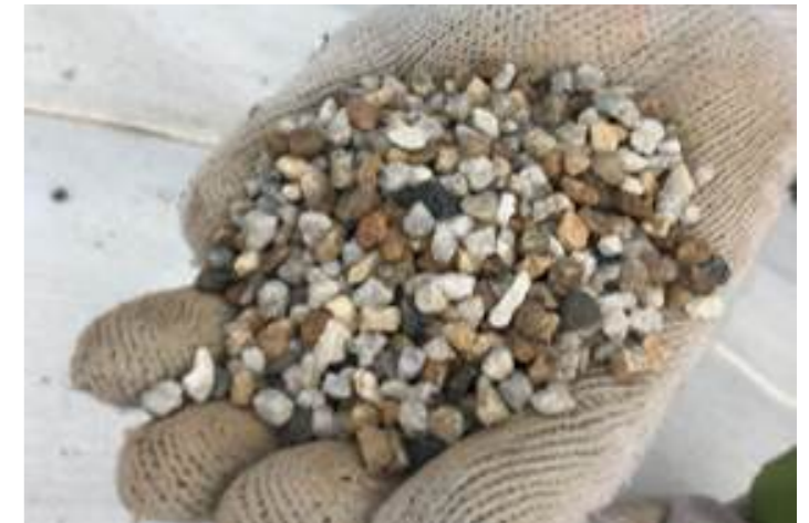
Hình 5.6: Sỏi dung trong lớp trung gian
